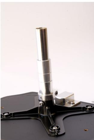
5.) Alle 3 Abstandshülsen über das Rohr schieben und mit etwas Kleber oder Klebeband gegen Herunterfallen beim Ausbau des Sitzes sichern
