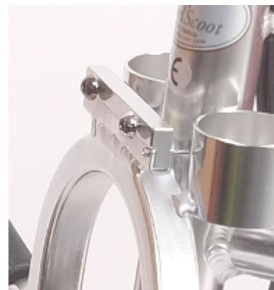
3.) Allentare leggermente le viti a testa tonda e far scorrere la **piattaforma di stoccaggio angolare (A)** con le aperture da buco per le chiavi sulle teste delle viti e abbassarla nella fessura. Serrare le viti.
