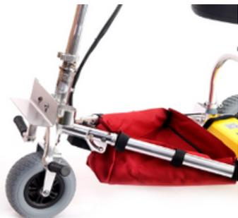
4.) Far scattare la **parte in plastica a forma di omega (distanziatore) (C)** sul piantone dello sterzo e fissarvi il **tubo di alluminio (C)** con le superfici in velcro.
