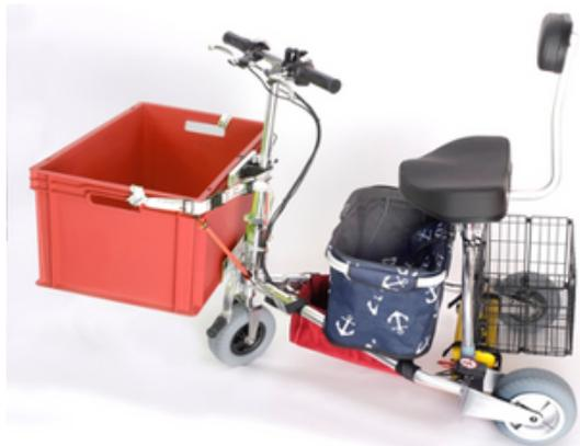
11.) Sollevare il box sulla **piattaforma di stoccaggio (A)** in modo che la marcatura sia allineata al piantone dello sterzo, posizionare le **cinghie (G)** attorno al **distanziatore Omega (C)** e fissarle, stringendo saldamente i tendicinghia. Fissare le due robuste **cinghie di tensionamento per bagagli (H)** alla scatola e al supporto per bastone e stampella. Questi agiscono come smorzatori di inclinazione.
