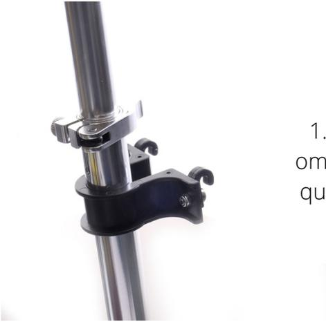
1.) Encaje la pieza de plástico con forma de omega en la columna de dirección de manera que las dos enganchas apunten hacia abajo.
