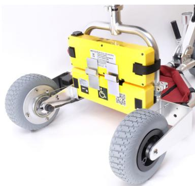
2. Coloque la segunda batería en los perfiles H y alinéela con la batería inferior. El cable de la batería debe estar en la parte inferior izquierda. De este modo, no es necesario reordenar las dos baterías cuando se trasladan. Fije la batería superior al soporte en U con las dos correas de velcro (ganchos).
