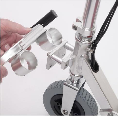
1.) Desserrez les deux boulons de montage, retirez l'ensemble du repose-pieds et remplacez-le par la plaque d'adaptation.
