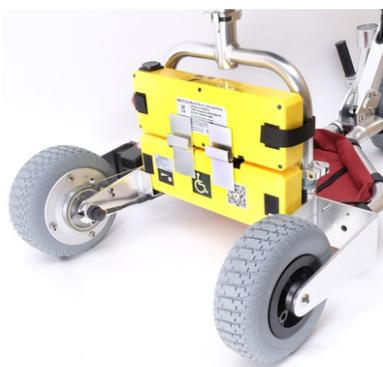
2.) Insérez la deuxième batterie et alignez-la sur la première, le pigtail orienté vers le BAS à gauche. Ainsi, il n'est pas nécessaire de changer les batteries de position pour les connecter au scooter. Fixez la batterie supérieure à l'étrier à l'aide des bandes velcro.
