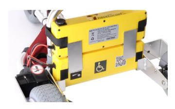
3. Posizionare la seconda batteria nei profili H e allinearla alla batteria inferiore. Il cavo della batteria deve stare in **basso a sinistra**, cosicché le due batterie non devono essere risistemate al momento di cambiarle.
